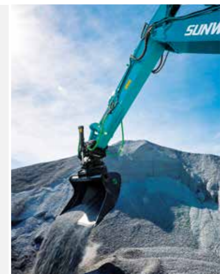
3 Zusatzleitungen als Serienausstattung sorgen für einfaches Arbeiten mit Tilt-Rotatoren
