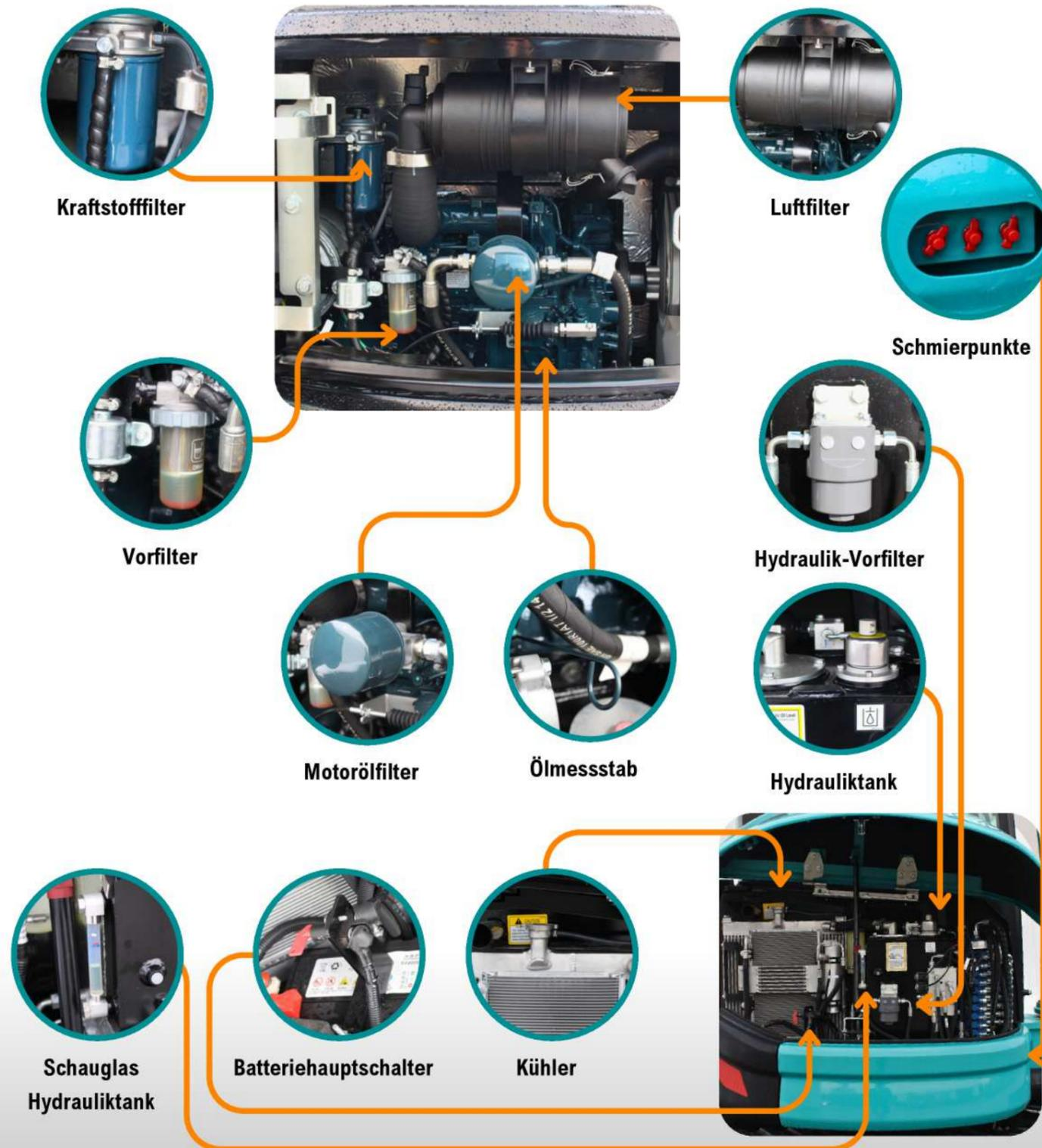
Der NR35UF Minibagger zeichnet sich durch eine besonders servicefreundliche Konstruktion aus. Durch die clevere Anordnung der Wartungs- und Servicepunkte ist der Zugang zu wichtigen Komponenten schnell und unkompliziert. Der Motorraum sowie die
